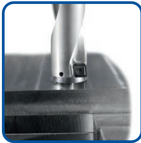
Foratura a pacchetto Bundle drilling
