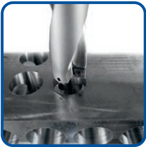
Foratura dal pieno Solid drilling
